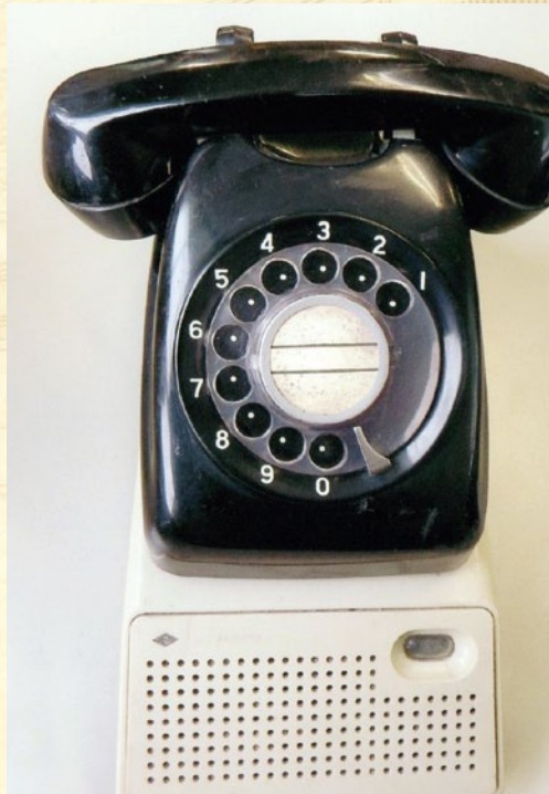
▶開業当時の放送電話機 (放送用スピーカー付)
