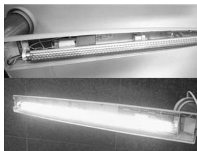
LED防犯灯の点灯前と点灯中（撮影の為、カバーは外してあります）
