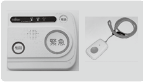
緊急通報装置
